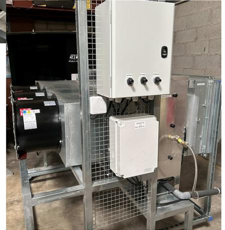
Kit de formation mobile : installation de complète de chambre froide pour formation à la soudure, aux montages et aux mises en service
